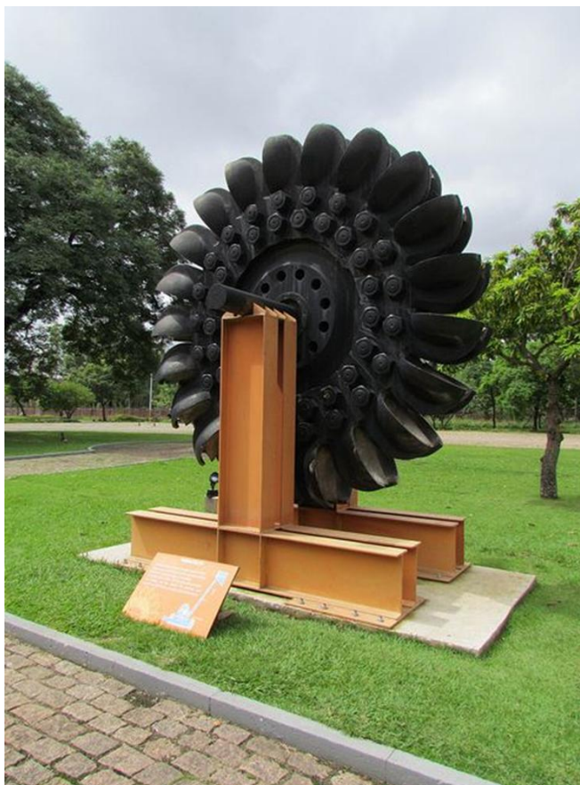
Figura 2: Turbina Pelton no Museu Catavento
